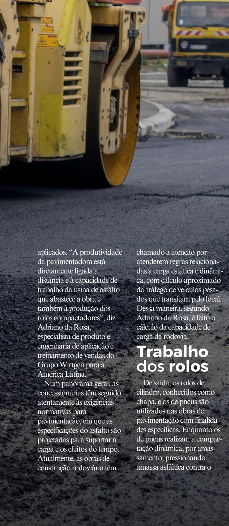
solo, o chapa compacta de forma estática quando está se movimentando, embora possa compactar também de forma dinâmica por vibração ou oscilação.
