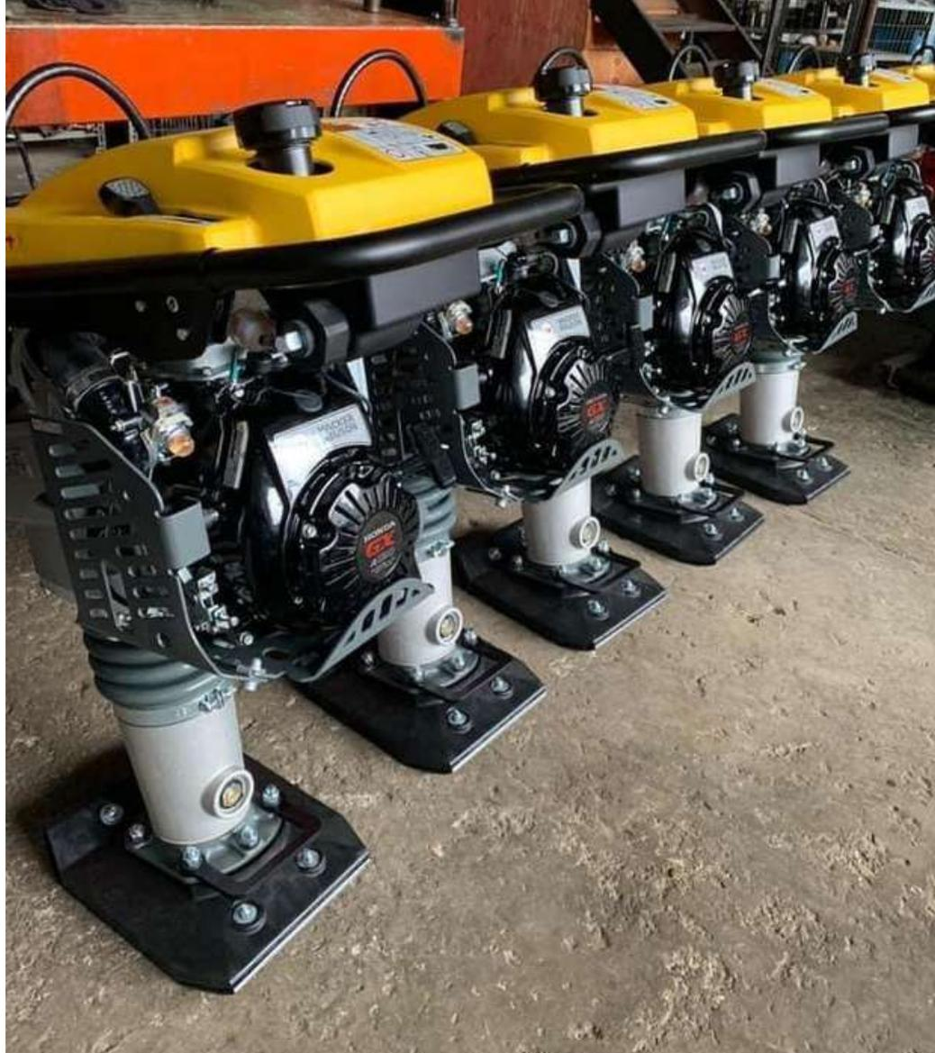
surgimento de falhas são a sanfona furada (normalmente por conta do manuseio realizado dentro de valas apertadas) e as sapatas danificadas devido à compactação de solos que não apresentam as características recomendadas para a utilização desse tipo de equipamento.
